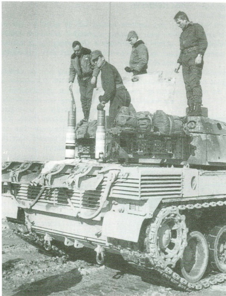
Een Leclerc tank wordt bevoorrad op het oefenterrein te Mourmelon, begin 1994. De pantsering aan de achterkant van de toren staat open, waardoor de munitie in de automatische lader kan worden geladen.
