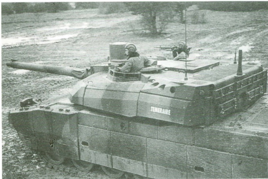
Een Leclerc tank tijdens beproevingen in Mourmelon, begin 1994. De achterkant van de toren is hier duidelijk zichtbaar. De naar voren gerichte openingen achterin de zijwand van de toren zijn de rookgranaatwerpers.
